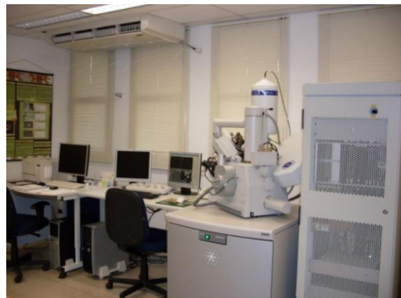
Figura 25. Microscopia Eletrônica de Varredura do Setor de Perícias Balísticas SEPBAL/INC/PF. Fonte: o autor.
