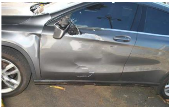
Figura 16. Amassamentos sem vincos e marcas de fricção. Fonte: os autores.
