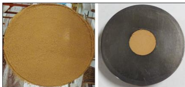
Figura 9. Lado esquerdo: amostra de argila e silte moída e peneirada a 0,2 mm; lado direito: amostra depositada e compactada em porta amostra para análise via difração de raios-X.
