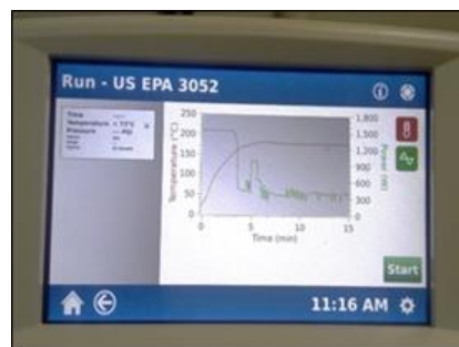
Figura 6. Programação do método 3052 USEPA aplicado na fração areia das amostras recebidas.
