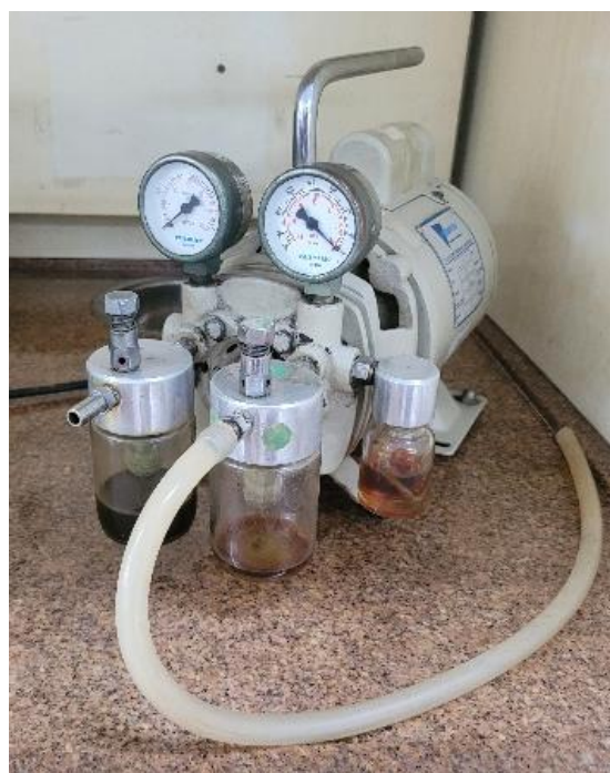
Figura 2. Bomba à vácuo utilizada na montagem do equipamento.
