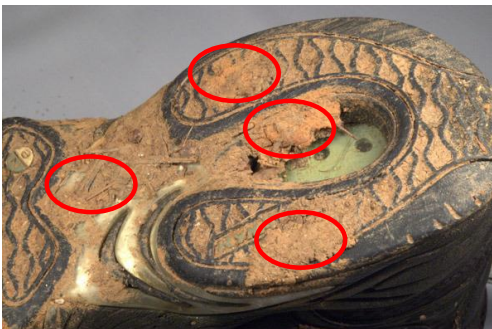
Figura 5. Demonstração de coleta de quatro repetições de vestígios de solo (círculos em vermelho) em superfície onde ocorreu intensa transferência e aderência de solo, favorecidas pelas ranhuras do calçado.
