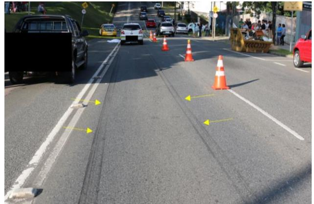
**Figura 5.** Vestígio de perturbação nas marcas de frenagem produzido no momento do contato entre o veículo atropelador e o corpo, evidenciando a área de impacto.
