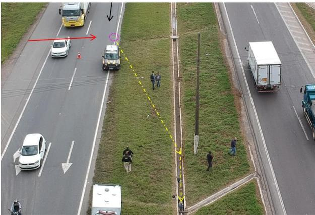
**Figura 7.** Determinação da área de impacto a partir da extrapolação das marcas da queda e atrito do corpo do pedestre contra o solo.
