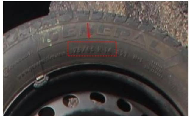
**Figura 12.** Ilustra as medidas do pneumático montado no veículo envolvido no acidente, em destaque no retângulo vermelho os algarismos 175/65 R14. Fonte: Dos autores.
