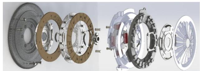
**Figura 2.** Vista explodida de componentes da embreagem. Fonte: Dos autores.
