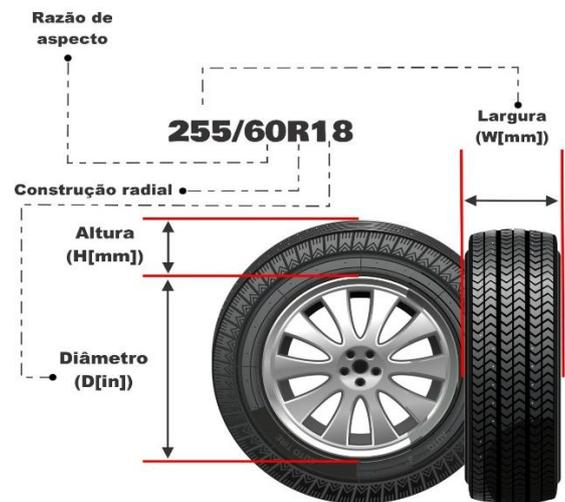
Figura 6. Ilustra as dimensões dos pneumáticos. Fonte: Dos autores.
