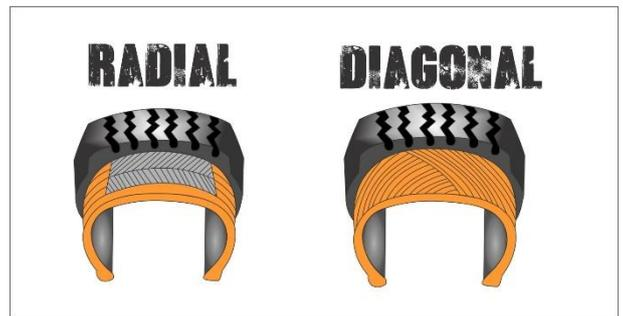
Figura 5. Ilustra os tipos de construção dos pneumáticos.
