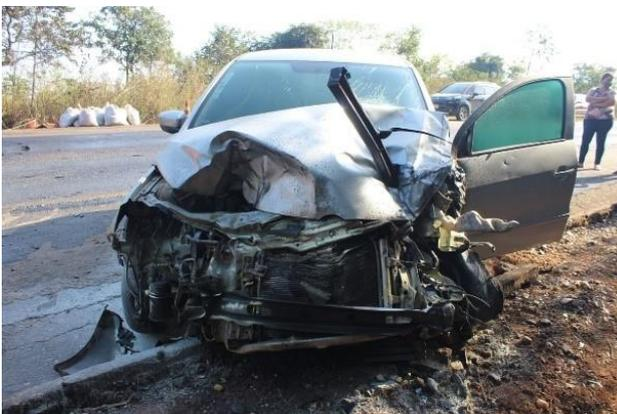
**Figura 10.** Ilustra a deformação na parte frontal do veículo envolvido na colisão, com avarias de grande monta na região onde está localizada a alimentação do sistema elétrico. Fonte: Dos Autores.
