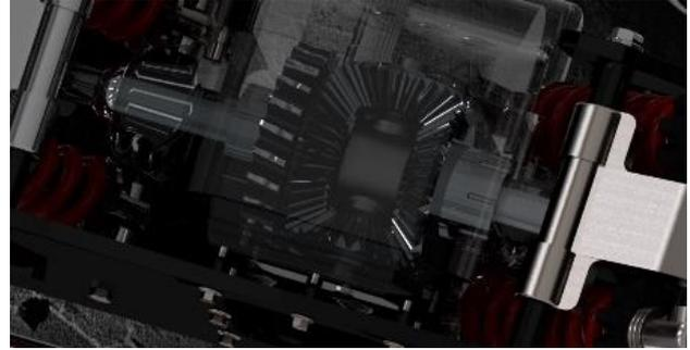
**Figura 4.** Elementos do diferencial. Fonte: Dos autores.
