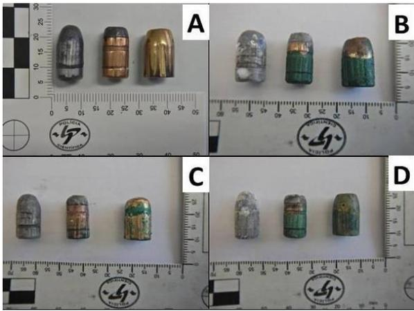
**Figura 7.** Vista dos projéteis após 5 dias em atmosfera oxidante, sendo: (A) controle negativo; (B) controle positivo (sem tratamento); (C) tratamento com PA; e (D) tratamento com WD.
