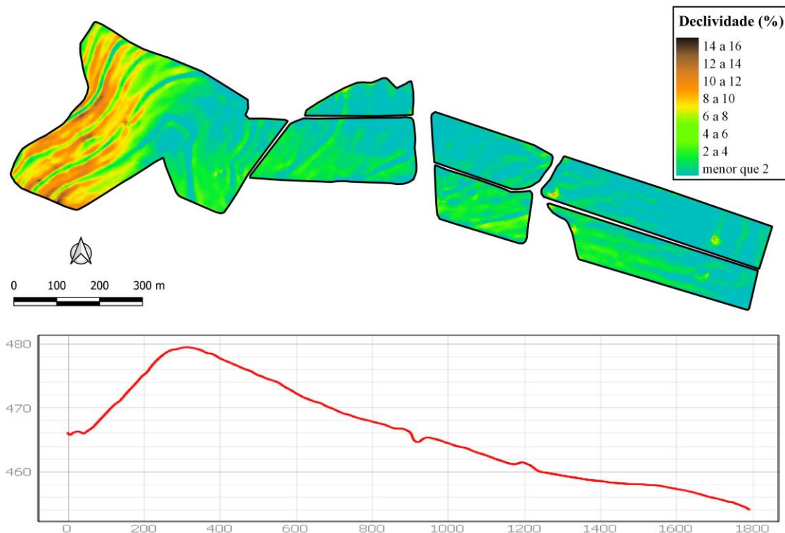
Figura 4. Mapa de declividade e perfil topográfico dos talhões inseridos na área de estudo.
