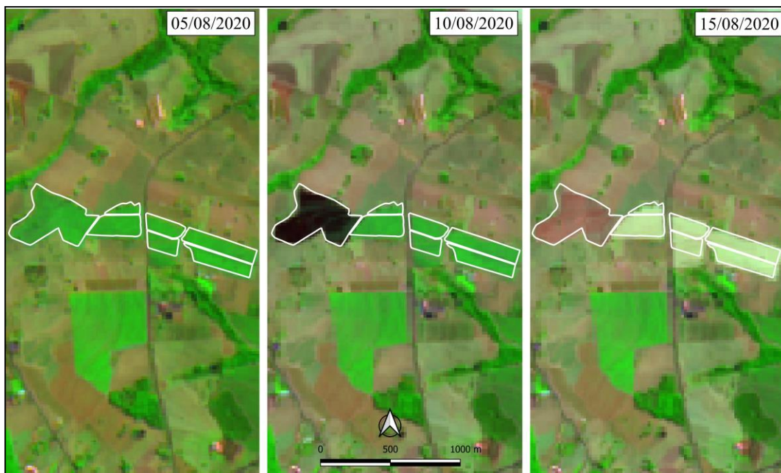
Figura 2. Comparação das composições falsa-cor R12G8AB4 da área de estudo nas datas de 05, 10 e 15 de agosto de 2020 evidenciando mudanças nos padrões de refletância da superfície terrestre compatíveis com incidência de fogo seguida de colheita da cana-de-açúcar atingida.
