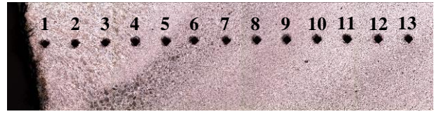
Figura 16. Microestrutura e perfil de impressões de microdureza Vickers na junta soldada – Ampliação 50x.
