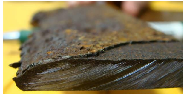
Figura 13. Corrosão – Amostra “Tampa”.
