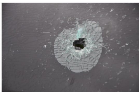
Fig. 18: Detalhe do terceiro disparo (4° teste).
