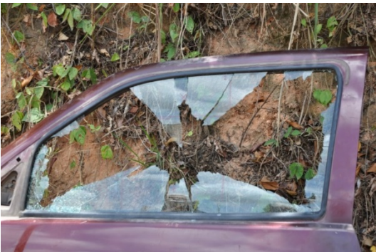
Figura 2. Resultado após o primeiro disparo no vidro sem película (1º teste)
