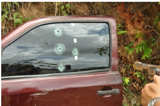
Figura 9. Quarto disparo no setor inferior direito do quadrante central (3º teste)
