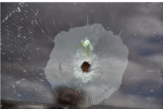
Figura 4. Disparo na região central do vidro com película e visão do aparecimento das linhas radiais após o primeiro disparo (3º teste)
