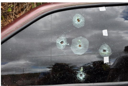
Figura 11. Quinto disparo no setor superior esquerdo do quadrante central (3º teste)
