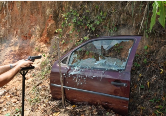
Figura 1. Disparo quadrante central e estilhaçamento do vidro sem película (1º teste)
