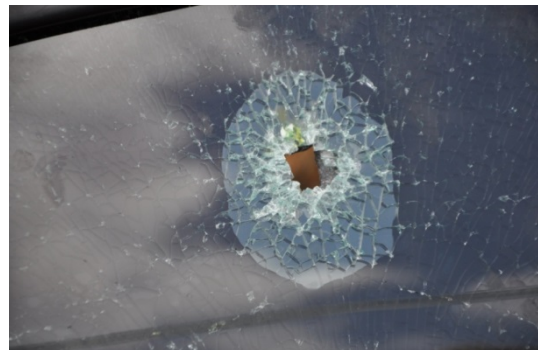
Figura 6. Detalhe do segundo disparo no vidro com película demonstra que a partir dele as linhas radiais não são mais evidentes (3º teste)
