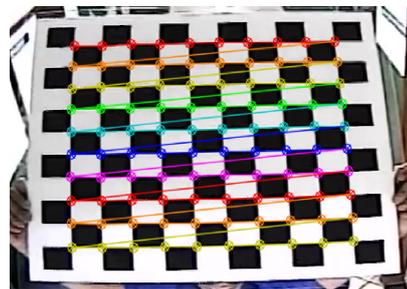
Figura 2. Exemplo de detecção dos cantos internos do padrão de calibração.
