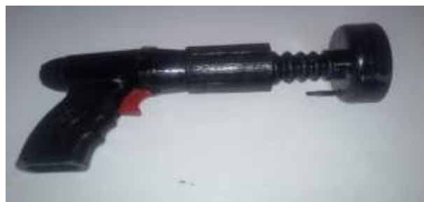
Figura 1. Pistola finca pinos com sistema de fixação à pólvora. Retirado de [4].
