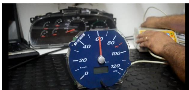
Figura 30. Agulha travou a 60 km/h quando se retirou a energia.
