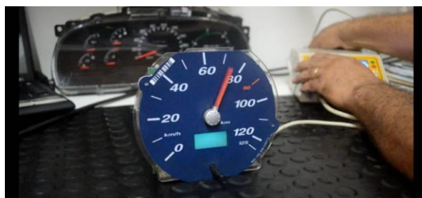
Figura 29: Ponteiro retornando próximo a 70 km/h.
