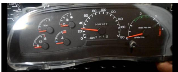
Figura 24. Ponteiro retornado aos poucos para a posição zero devido às batidas com a mão na parte superior de equipamento.
