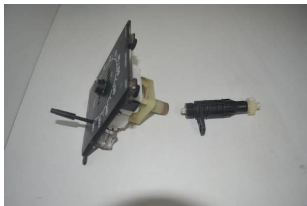
Figura 17. Conexão na parte traseira do velocímetro por uma espécie de mandril.
