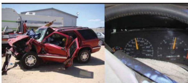
Figura 13. O ponteiro indica 48 mph o que corresponde a 77,2 km/h.
