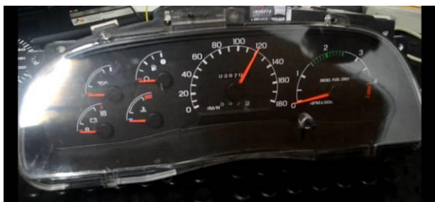
Figura 23. Modelo eletromecânico: ponteiro travado a 120 km/h (F-350).
