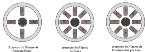
Figura 4. Métodos para aumentar a resolução do motor de passo.
