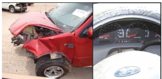
Figura 12. O ponteiro do velocímetro marca zero.
