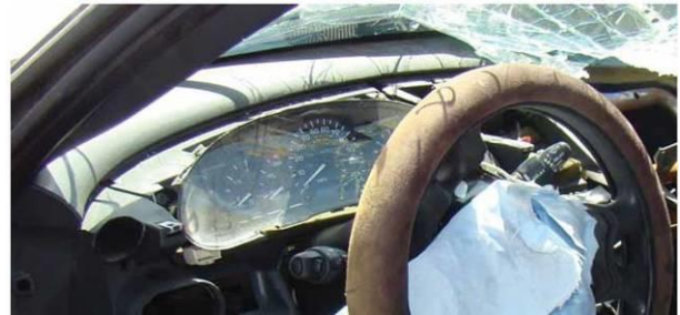
Figura 10. A velocidade registrada pelo ponteiro após a colisão é muito próxima de zero em torno de 3,2 km/h.
