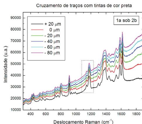
**Figura 8.** Espectros Raman coletados, com laser de 514 nm, sobre o cruzamento de traços de tintas de cor preta, com o traço da “caneta 1a” localizado abaixo do traço da “caneta 2b”. As profundidades de cada medida estão diferenciadas por cores, sendo que o zero é a superfície do papel. A região pontilhada mostra os picos Raman que foram analisados através de um tratamento matemático simples.
