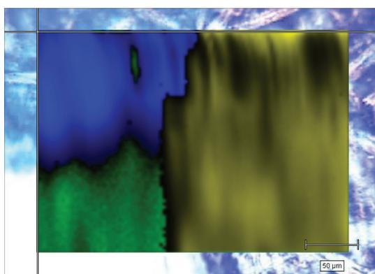
**Figura 18.** Composição das principais componentes da análise da correlação dos espectros Raman do mapeamento 2D com os espectros Raman isolados das fibras do papel (agora na cor verde) e das tintas azuis das canetas 7e (azul) e 2b (amarelo).
