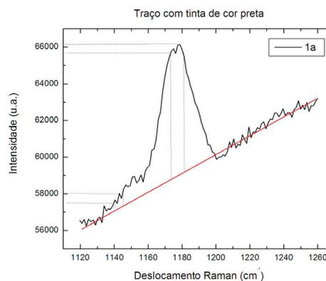
**Figura 12.** Detalhe dos picos de interesse, com o tratamento matemático, do espectro Raman coletado para o traço de tinta de cor preta, isoladamente. A reta de cor vermelha é a linha de base calculada para ambos os picos. As linhas pontilhadas mostram a região de pontos do espectro que entraram no cálculo da média da altura dos picos.
