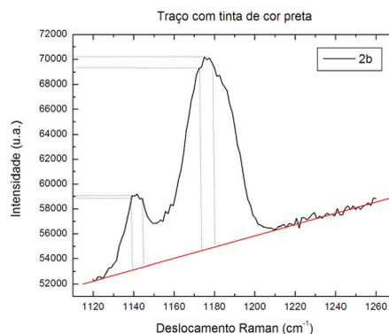
**Figura 11.** Detalhe dos picos de interesse, com o tratamento matemático, do espectro Raman coletados para o traço de tinta da “caneta 2b” de cor preta, isoladamente. A reta de cor vermelha é a linha de base calculada para ambos os picos. As linhas pontilhadas mostram a região de pontos do espectro que entraram no cálculo da média da altura dos picos.
