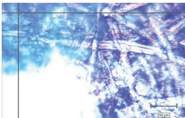
**Figura 14.** Região próxima ao cruzamento de traços das tintas de cor azul das canetas 7e (horizontal) e 2b (vertical), ampliada através da objetiva de 20x, onde foi realizado o mapeamento 2D de espectros Raman.
