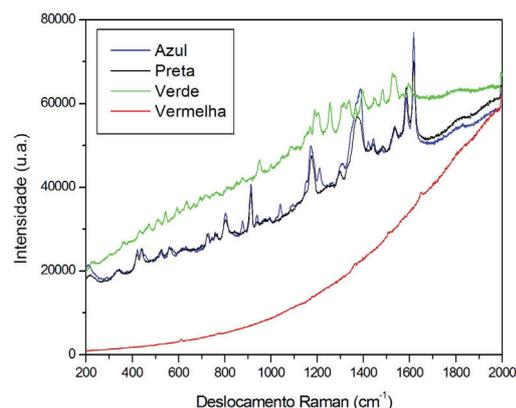
**Figura 2.** Espectros Raman coletados, com laser de 514 nm e objetiva de 50x, para um exemplo de cada cor de tinta estudada, aleatoriamente selecionada.
