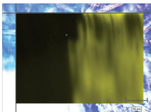
**Figura 17.** Principal componente da análise da correlação dos espectros Raman do mapeamento 2D com o espectro Raman da tinta da “caneta 2b” (vertical), em amarelo.
