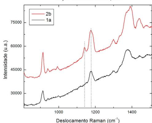
**Figura 9.** Detalhe das regiões de interesse dos espectros Raman coletados, com laser de 514 nm, para os traços de tintas de cor preta, isoladamente. O espectro de cor vermelha é referente à tinta da “caneta 2b” e o de cor preta à tinta da “caneta 1a”. As linhas verticais pontilhadas mostram a principal diferença entre os espectros, ou seja, a ausência do pico localizado em 1141 cm<sup>-1</sup> para a tinta da “caneta 1a”.
