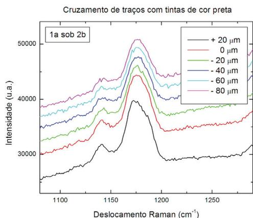
**Figura 10.** Detalhe dos espectros Raman realizados sobre o cruzamento de traços de tintas de cor preta, com o traço da “caneta 1a” localizado abaixo do traço da “caneta 2b”, correspondente aos picos da região pontilhada da Fig.(2).
