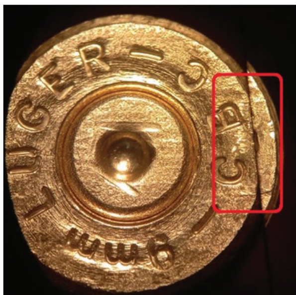
Figura 3. Imagem obtida no microscópio comparador balístico. À esquerda, estojo padrão da pistola Canik. À direita, estojo questionado coletado em Engenheiro Passos.
