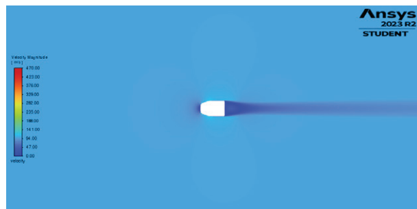
Figura 4. Simulação estabilizada do projétil do cartucho CBC - 40 S&W ETPP a Mach 0,3.
