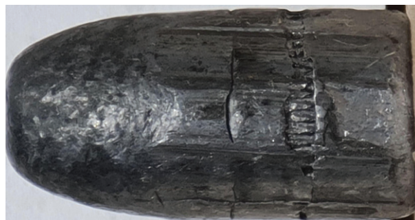
Figura 1. Projétil de calibre .38 SPL (chumbo ogival) deformado após ser expelido por um cano de arma de fogo.
