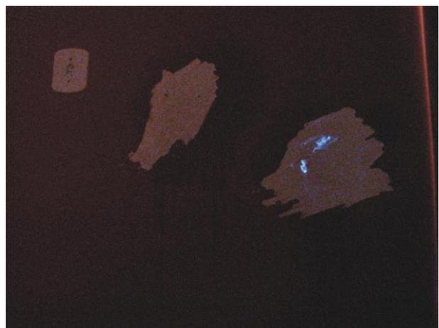
**Figura 4.** Após a retirada de parte do revestimento e aplicação do luminol no escuro observa-se a quimiluminescência.
