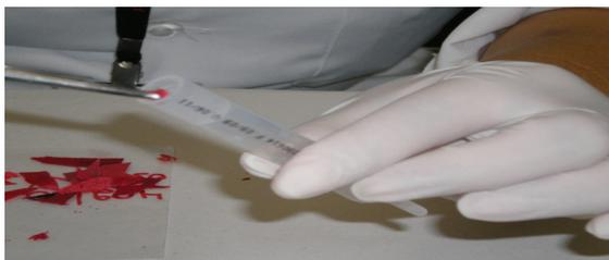
**Figura 5.** Procedimento "B": introduz-se um fragmento da amostra pelo orifício do tubo coletor
