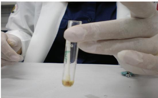
**Figura 6.** Procedimento "C": um pedaço da amostra é colocado em um tubo de ensaio junto com o conteúdo de solução de 1 tubo coletor.
