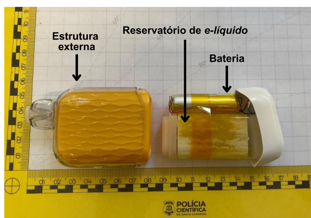
Figura 2. Estrutura externa de um DEF (à esquerda) e estrutura interna (à direita), evidenciando o reservatório de e-liquido e a bateria após abertura manual. Fonte: os autores.
